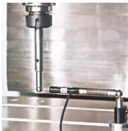
Контроль круглости датчиком ball-bar
