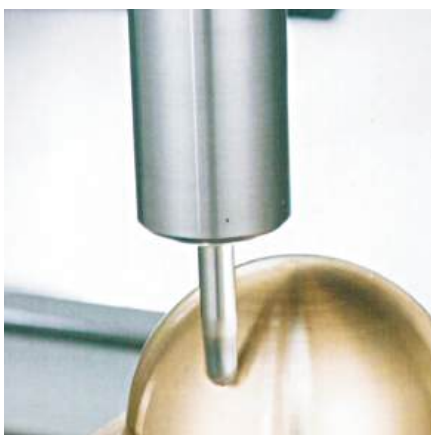
Контрольная обработка полусферы в трехмерном пространстве
